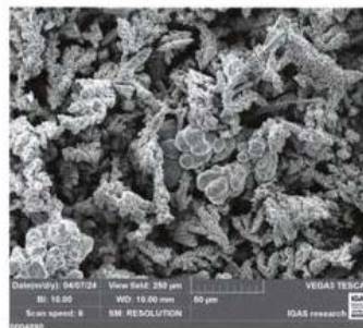
Fig. 3: 0004890, Cu powder. View field: 250µm, scale: 50µm.
